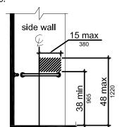
FIGURE 608.5.1 TRANSFER TYPE SHOWER COMPARTMENT CONTROL LOCATION
