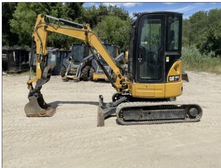
Figure 2-8. CAT 303.5 Mini Excavator
