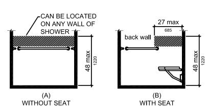
FIGURE 608.5.2 STANDARD ROLL-IN TYPE SHOWER COMPARTMENT CONTROL LOCATION
