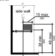
FIGURE 608.5.1 TRANSFER TYPE SHOWER COMPARTMENT CONTROL LOCATION
