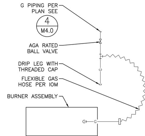
**3 IRH BURNER GAS CONNECTION DETAIL**
