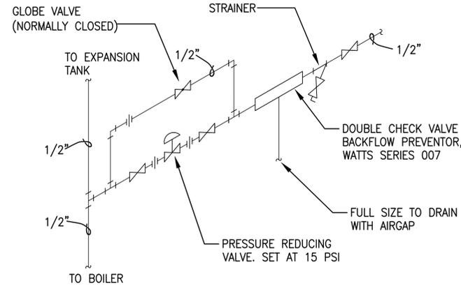
**2 BOILER MAKE-UP WATER DETAIL**
