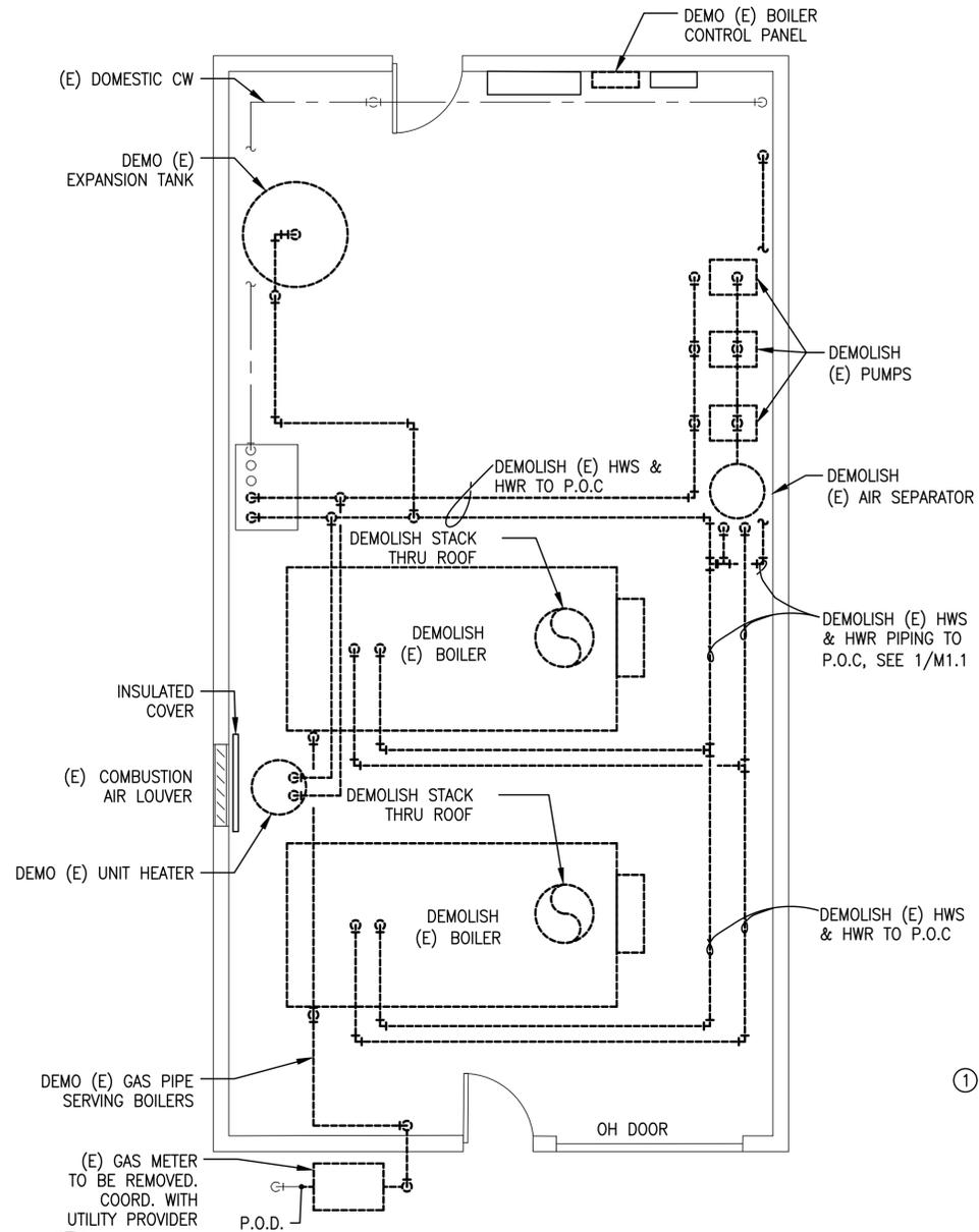
**1 BOILER BUILDING - DEMOLITION PLAN**
