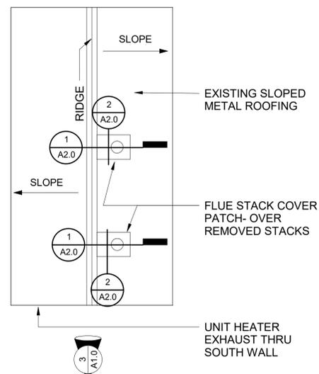
**2** BOILER ROOM - ROOF PLAN - STACK COVER LOCATIONS
